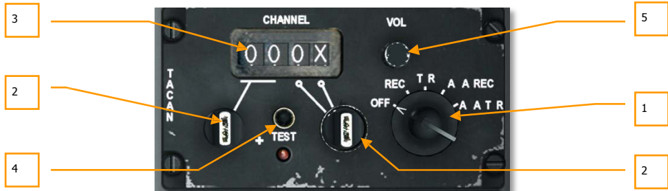
Şekil 128. TACAN Denetim Paneli
