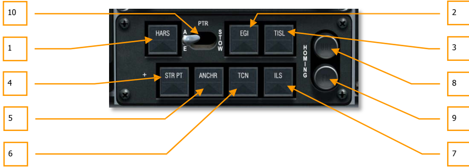
Şekil 90. Yöngüdümlü Kip Seçim Paneli
