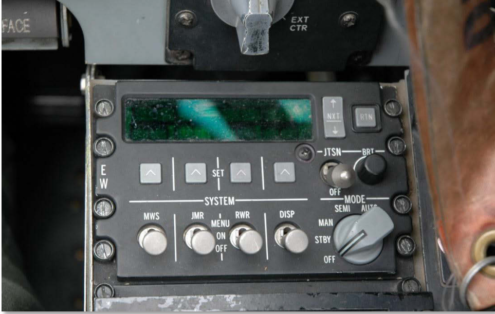
Şekil 39. Karşıönleme Sinyal İşleyici [CMSP] Paneli
