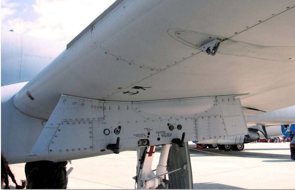
Şekil 42. Mühimmat Uçbirimi ve Tek Tahliye Rafı
