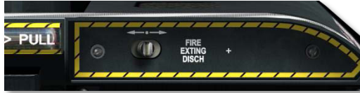
Şekil 93. Yangın Söndürücü Boşaltım Anahtarı
