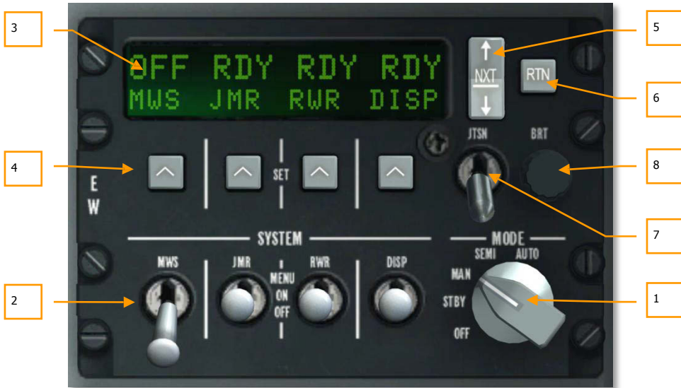
Şekil 288. CMSP Panel Test Kipi
