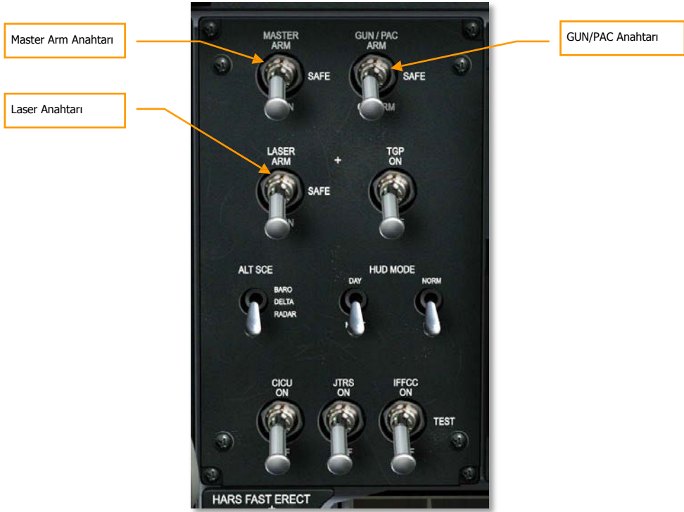
Şekil 385. Armament HUD Control Panel
