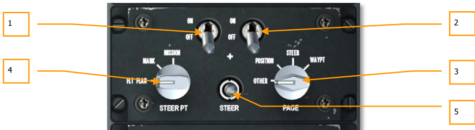
Şekil 131. Yardımcı Havaelektronik Paneli (AAP)
