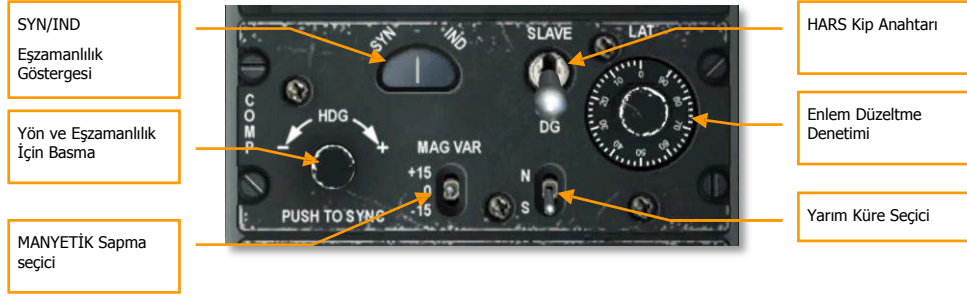
Şekil 340. HARS Paneli
