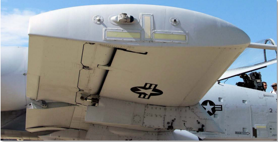
Şekil 35. Kanat Ucu ve Yatırıcı
