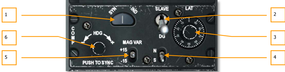
Şekil 130. HARS Denetim Paneli
