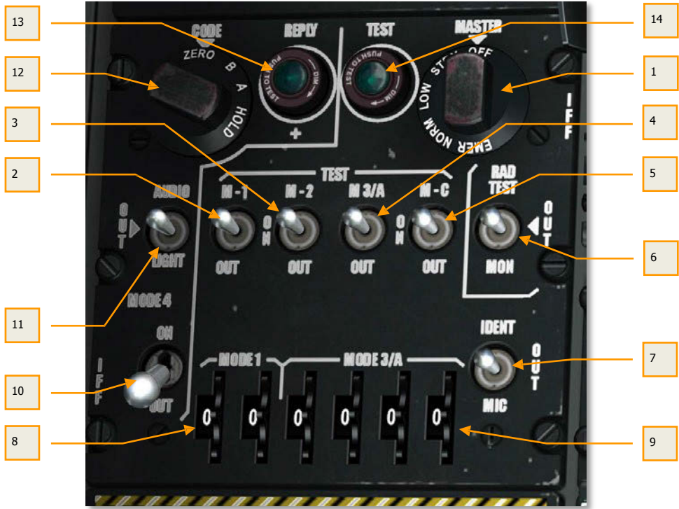
Şekil 118. IFF/SIF Denetim Paneli
