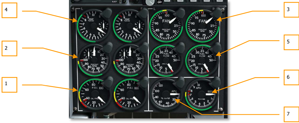
Şekil 100. Motor İzleme Araçları
