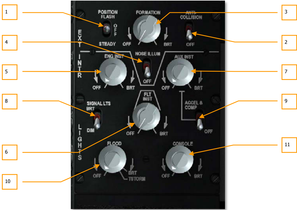
Şekil 126. Aydınlatma Denetim Paneli
