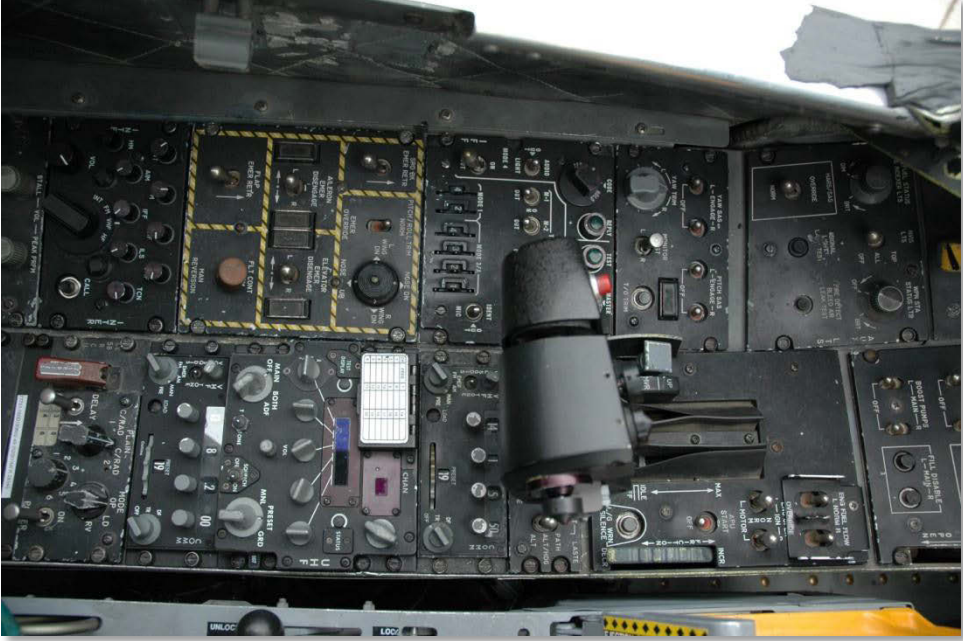
Şekil 38. Sol Panelde Gösterilen VHF ve UHF Radyoları
