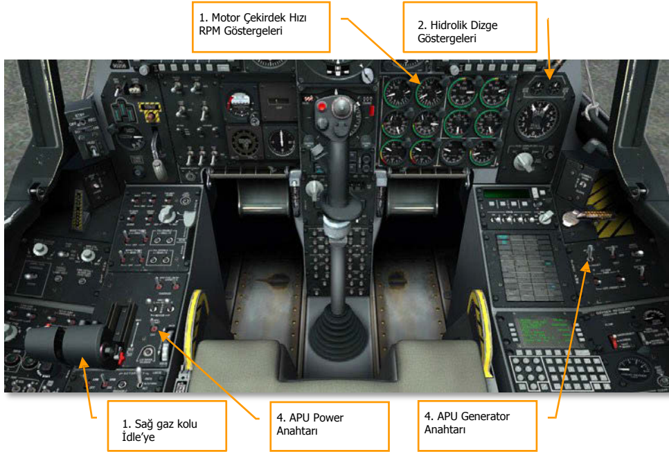
Şekil 317. Sağ Motor Çalıştırma
