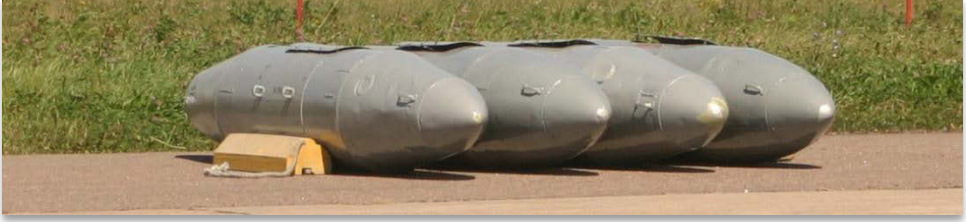
Şekil 67. MXU-648 Taşıyıcı Podu
