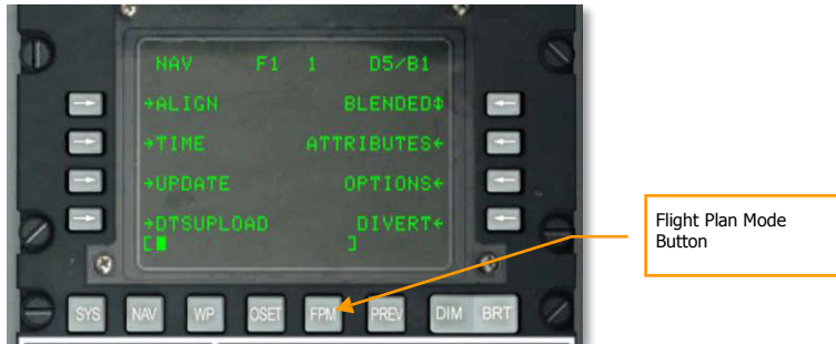
Şekil 324. CDU Flight Plan Kipi Düğmesi
