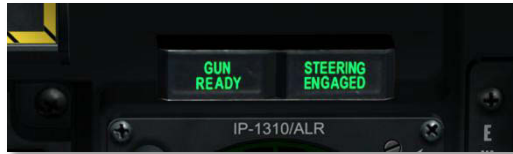
Şekil 84. Top ve Burun Tekerı Yönlendirme ışıkları
