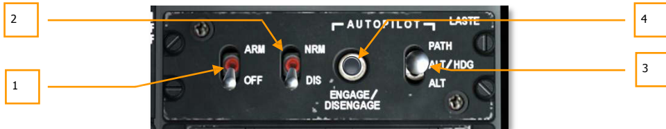
Şekil 109. LASTE Denetim Paneli
