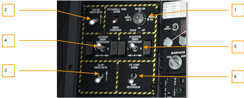
Şekil 119. Acil Uçuş Denetim Paneli
