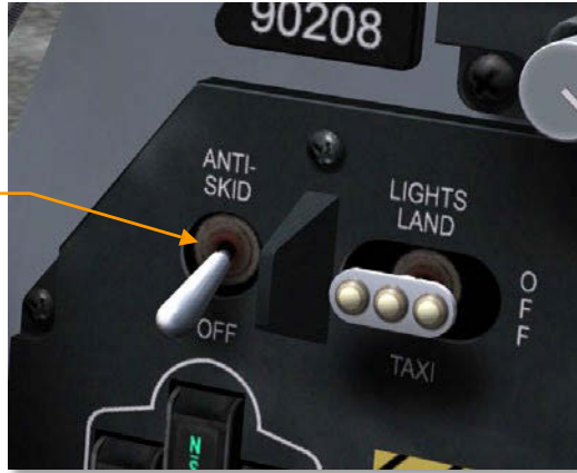
Şekil 337. SAS ve Kayma Önleyici anahtarları
