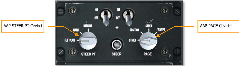
Şekil 342. Auxiliary Avionics Panel (AAP)
